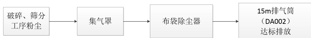
图 4-2 破碎、筛分废气处理工艺流程
