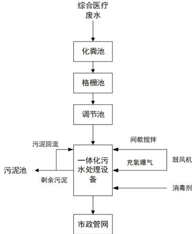
图 4.1-1 废水处理工艺流程图
