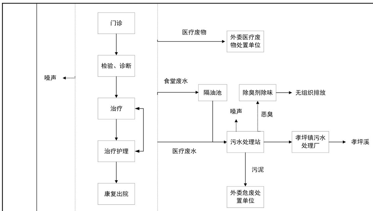
**图 2.11-1 项目工艺流程及产污节点图**
