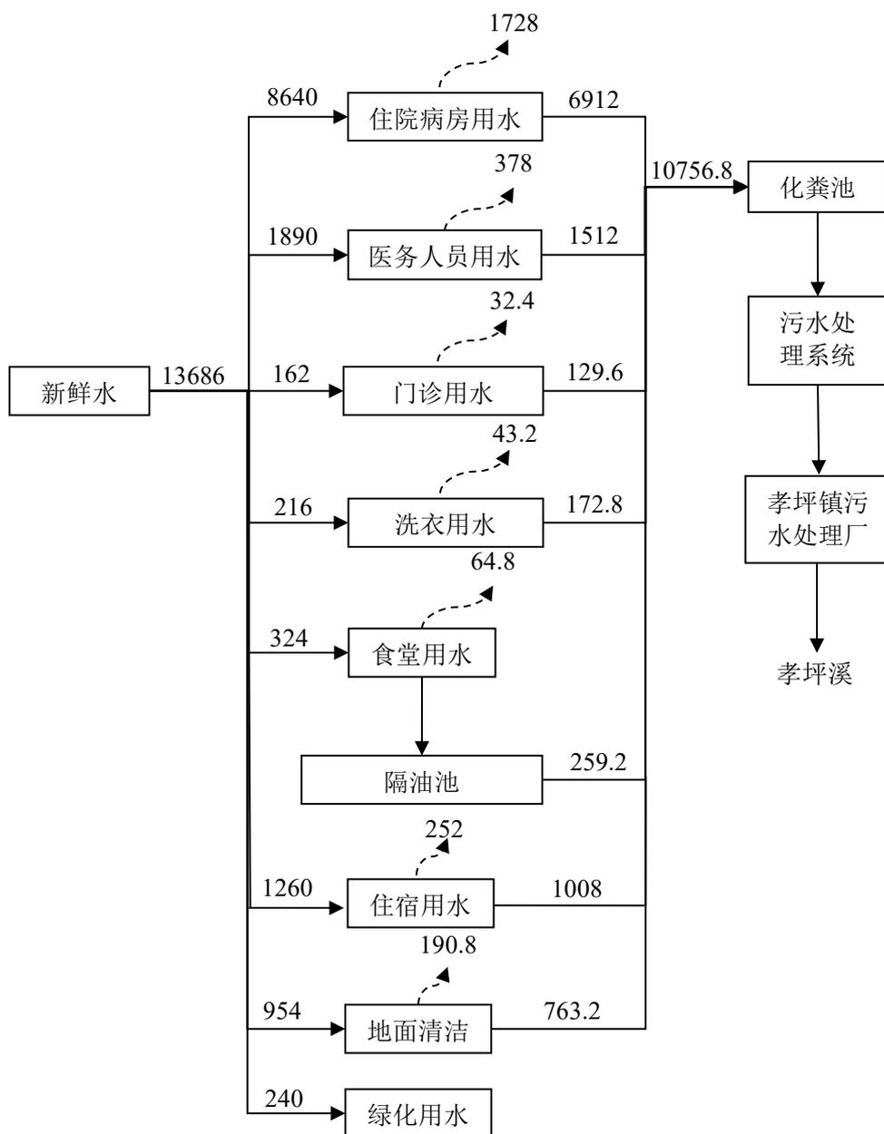
图 2.7-1 项目水平衡图单位: m³/a
