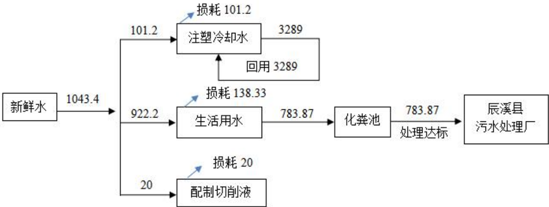
图 2-1 扩建项目水平衡图 单位：m 3 /a
