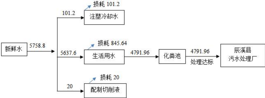
图 2-2 扩建后项目总水平衡图
