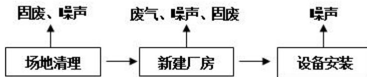
图4-1施工期工艺流程及产污环节示意图
